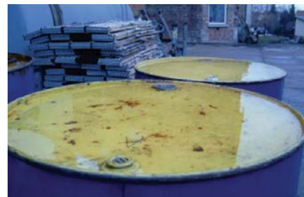
So bitte nicht! Wassereintritt durch Fassatmung.
