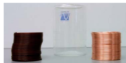
Kupferspule vor und nach dem RPVOT-Test
