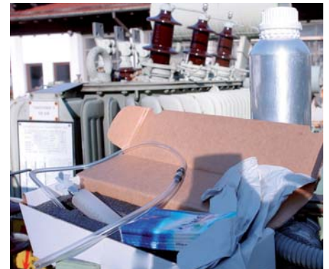
Analysen-Set für Transformatorenöle: Versandkarton mit 20 ml Glasspritze, Probenentnahmeschlauch, Schutzhandschuhe, Papiertücher, Probenbegleitschein und optional die 1 l Aluf flasche
