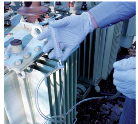
Für die Probenentnahme vorbereitete Glasspritze inklusive 3-Wege-Hahn und Entnahmeschläuche
