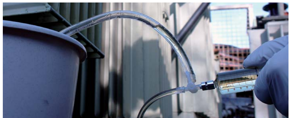
Probenentnahme in Glasspritze, links im Bild: Eimer als Spülgefäß
